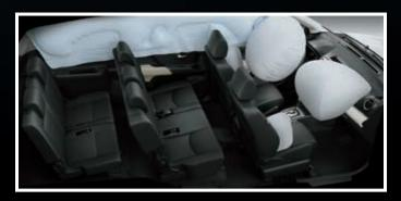
Disponibilidad de 6 airbags de última generación enfocados en garantizar la seguridad de todos los ocupantes del vehículo, incluso de la tercera fila de asientos. El nuevo Toyota Rush incluye airbags frontales para el conductor y el copiloto, airbags de cortina y airbags laterales.
