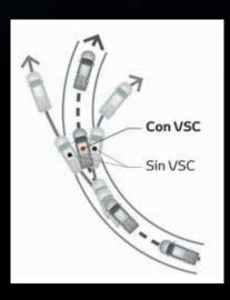
Este sistema proporciona asistencia inteligente al realizar curvas y lograr que el vehículo siga la trayectoria trazada por el conductor sin derrapar.
