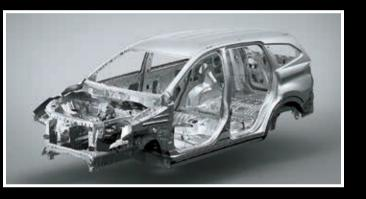
Esta carrocería esta diseñada para absorber y dispersar la energía durante un impacto minimizando los efectos sobre sus ocupantes.
